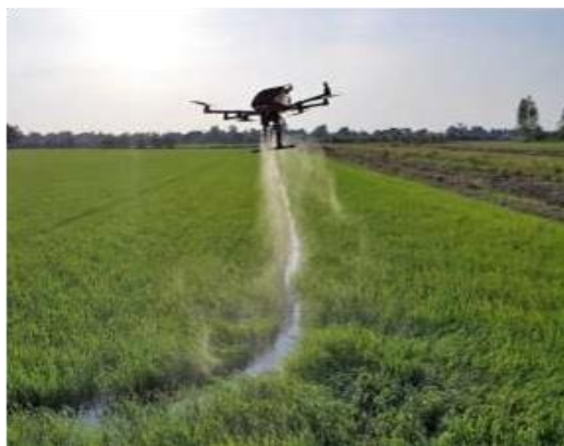
б – агродрон DJI Agras T40 на обработке поля пестицидами
