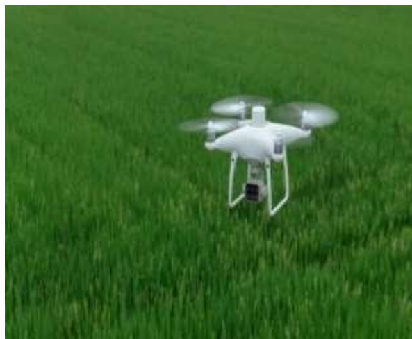
а – беспилотник DJI Phantom 4 Multispectral 1 V2.0, выполняющий анализ засоренности поля сорняками
