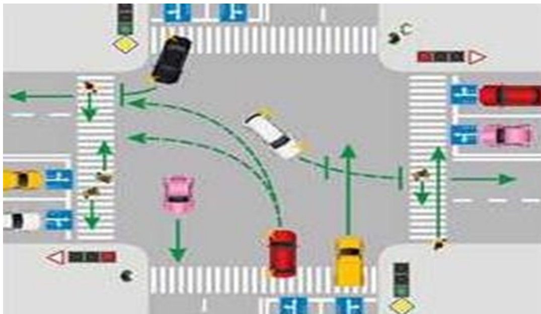
Рисунок 1 – Совершение поворота транспортного средства «налево» в период разрешения движения встречному направлению движения «прямо – направо» и «прямо – налево»
